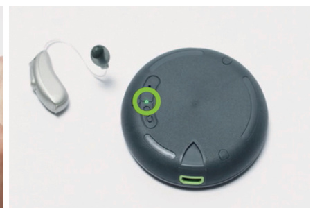
Hörgerät neben Roger Select iN legen bis die LED durchgehend leuchtet
